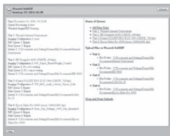
Abbildung 9: Anzeige des RIP-Systems über das Netzwerk
